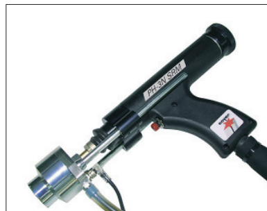
PH-3N SRM -pultinhitsauspistooli
